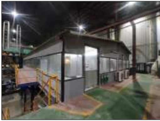
รูปที่ 68 ห้องควบคุม (Control Room) เพื่อกันเสียงระหว่างเครื่องจักร กับผู้ปฏิบัติงาน
